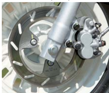
Unutar naplatka od 12 cola ima mjesta samo za mali disk, ali on efikasno zaustavlja ovaj skuter
